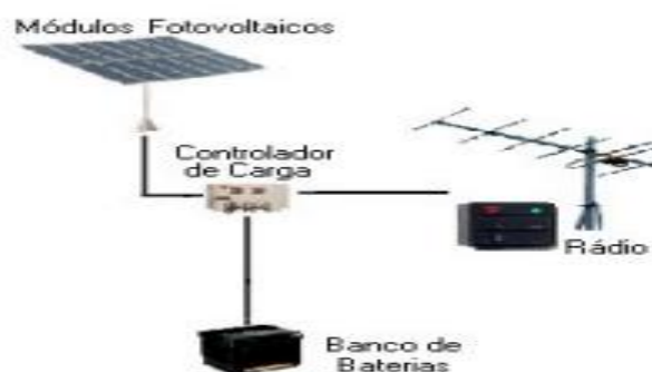
Figura 1 – diagrama esquemático sistema fotovoltaico (Fonte: http://www.cresesb.cepel.br ).
